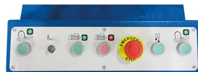
Ovládací prvky zleva: Levý START řezání, Mikrodávkovací zařízení, Motor ZAP, Motor VYP, Nouzový vypínač, Upínání, pravý START řezání
