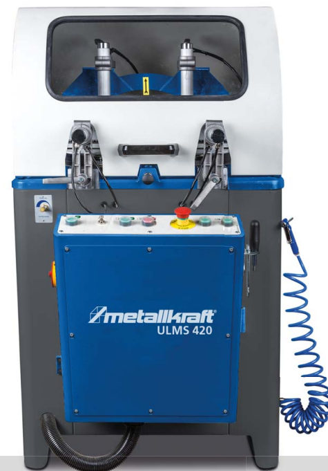
Ovládací prvky zleva: Levý START řezání, Mikrodávkovací zařízení, Motor ZAP, Motor VYP, Nouzový vypínač, Upínání, pravý START řezání
